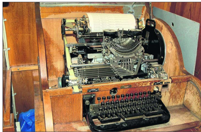
Zur Ausrüstung der Funker an Bord des Feuerschiffs „Laesö Rende“ gehört auch dieses betagte Gerät, das Wetterberichte ausdrückt, die über Radiowellen empfangen werden. Fotos Zimmer
